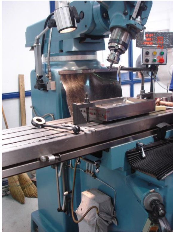
Resim 2.27: İş parçasının cıvata ve pabuçlarla bağlanması
