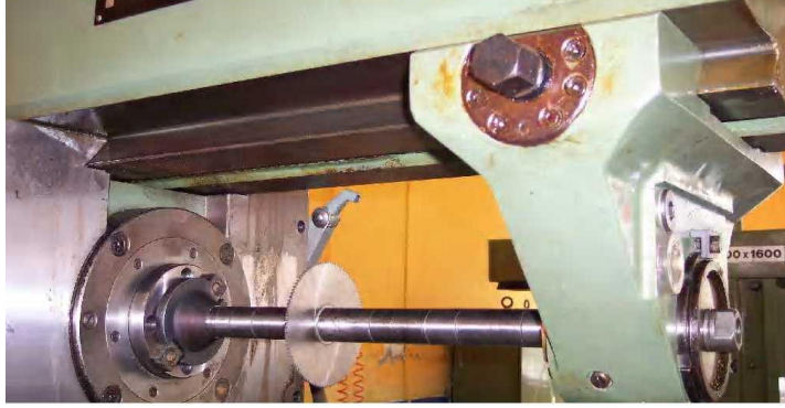
Resim 2.16: Freze tezghı st bařlık ve aparatları
