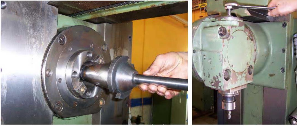
Resim 2.14: Malafa milinin fener miline takılması
