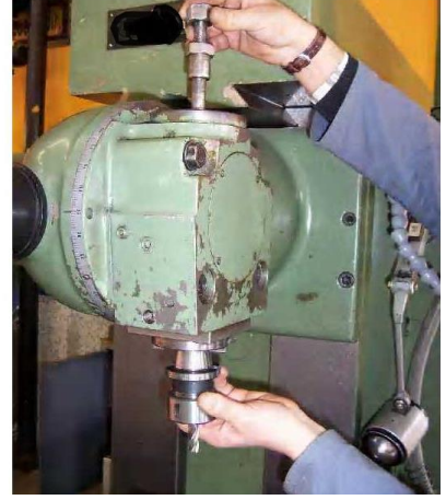
Resim 2.18: Kısa malafa mili ve uç vidasının dik başlığa takılışı
