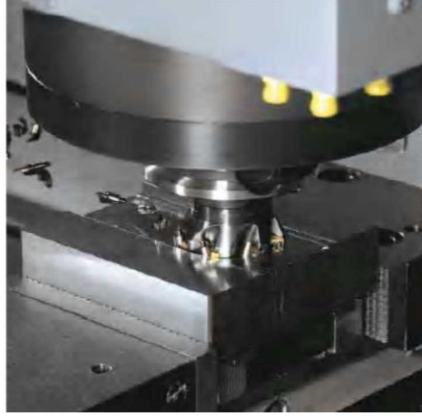
Resim 2.29: Düzlem yüzey frezeleme
