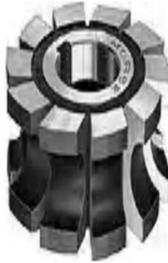
Resim 2.13: Profil freze çakısı
