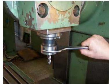
Resim 2.19: Parmak freze çakısının pense takılışı ve sıkılması
