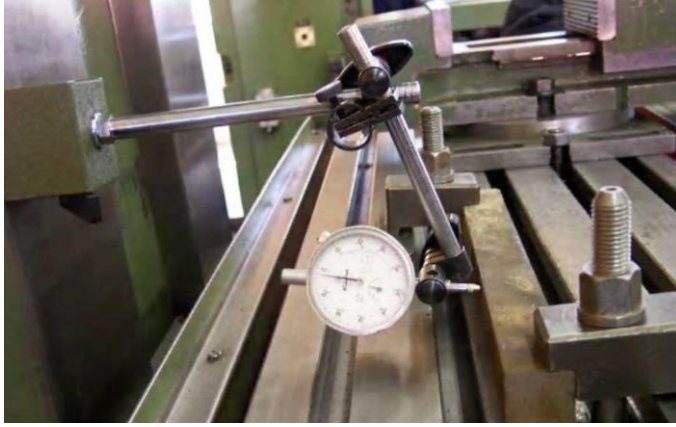
Resim 2.26: Komparatörle iş parçasının gövdeye paralel bağlanması
