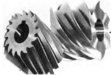
Resim 2.6: Sağ ve sol helis silindirik frezeler
