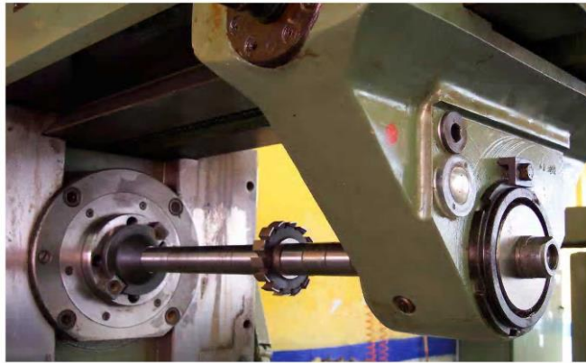
Resim 2.15: Mors konik saplı malafa ve freze akısı
