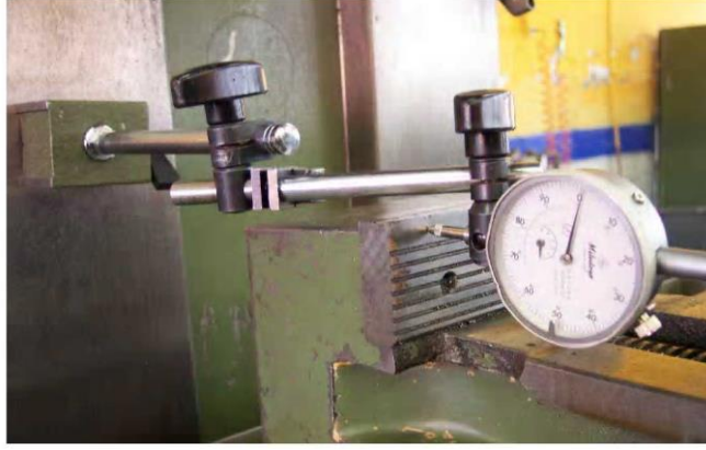
Resim 2.22: Mengene ağızlarının komparatörle gövdeye paralellik ve diklik kontrolü
