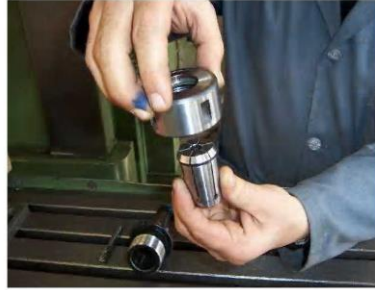
Resim 2.19: Parmak freze çakısının pense takılışı ve sıkılması
