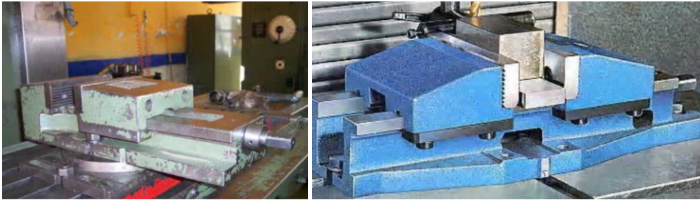
Resim 2.23: Vidalı mengene ve işin bağlanması
