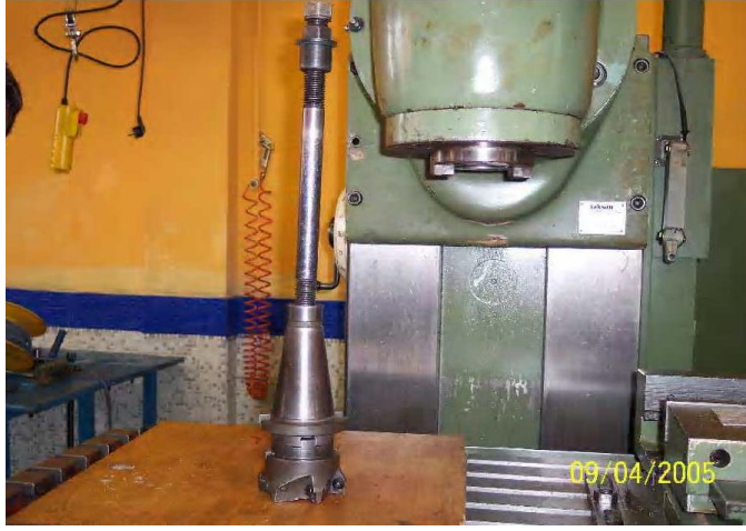
Resim 2.18: Kısa malafa mili ve uç vidasının dik başlığa takılışı
